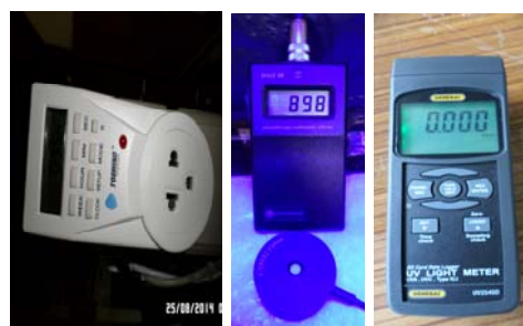
รูปที่ ๔ เครื่องนับชั่วโมงการทำงานของหลอด เครื่องมือทดสอบ LED Phototherapy
