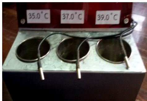
รูปที่ 4 แสดงภาพเครื่องสร้างอุณหภูมิเพื่อสอบเทียบฯปรอทวัดไข้
