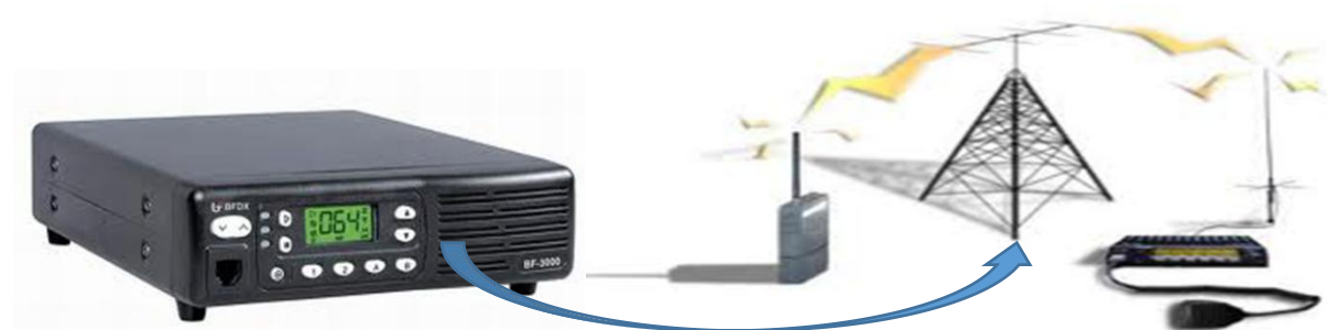
รูปที่ ๔.๖ แสดงเครื่องทวนสัญญาณวิทยุคมนาคม และ ระบบทวนสัญญาณวิทยุคมนาคม
